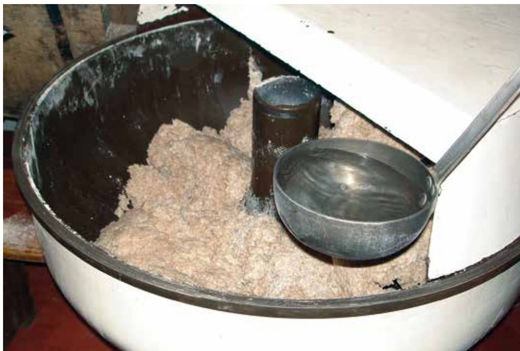
ALL'INIZIO DEGLI ANNI 80, NEL FORNO È STATA INTRODOLTA L'IMPASTATRICE MECCANICA CHE HA LA FUNZIONE DI AMALGAMARE I VARI INGREDIENTI (FOTO P. MINETTI)
